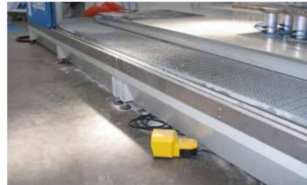
Vorderer Recyclingtank für Wiederverwendung des Arbeitswassers versehen mit einem Abdeckgitter zur Gewährleistung des einfachen Zugangs des Bedieners zum Arbeitsbereich.
