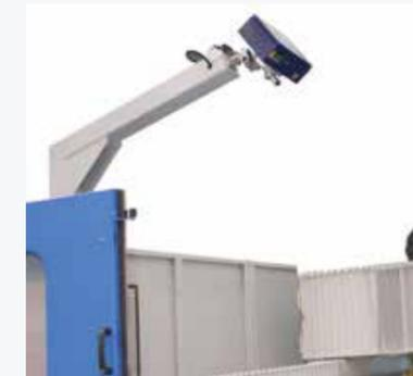
Laserprojektor für Positionierung der Vakuumsauger.
