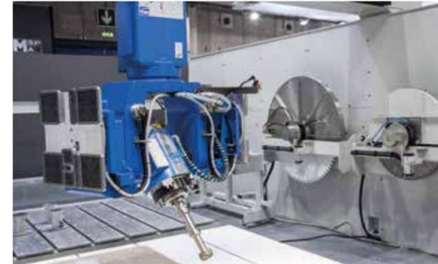
Vakuummanipulator mit einer maximalen Hebekraft von 1.000 kg. Er ermöglicht das Versetzen auch schwerer Werkstücke.
