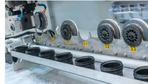
Werkzeugkit um Bohren eines 90° Ausschnittes und Politur der Innenkanten ausgestattet mit seinem eigenen Werkzeugmagazin.
