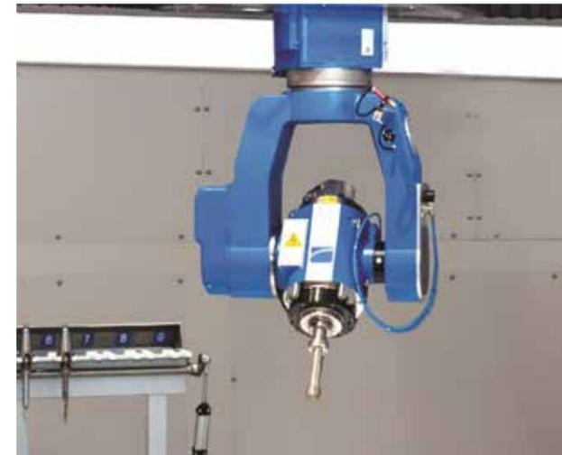
Tête 5 axes pouvant accueillir une puissante électro-broche ISO 50, jusqu'à 23 Kw.
