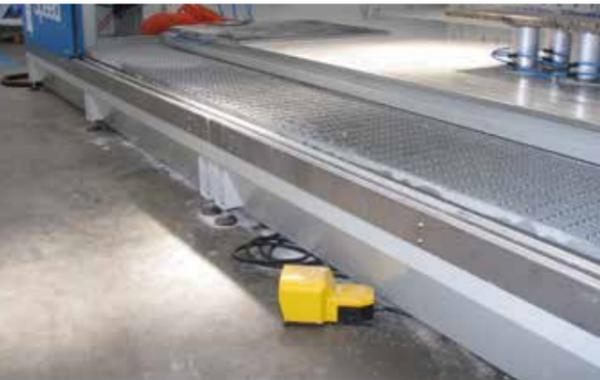
Vasque avant pour le recyclage de l'eau d'usinage, munie d'un caillebotis pour faciliter l'accès à la machine.
