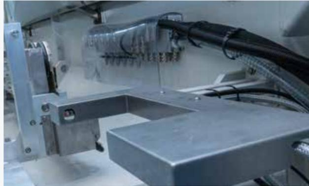
Caméra digitale avec boîtier de protection pour l'acquisition automatique des plaques.
