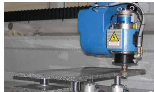
Electro-broche robuste de 30 kW, garantissant la puissance nécessaire à l'usinage des blocs de forte épaisseur.
