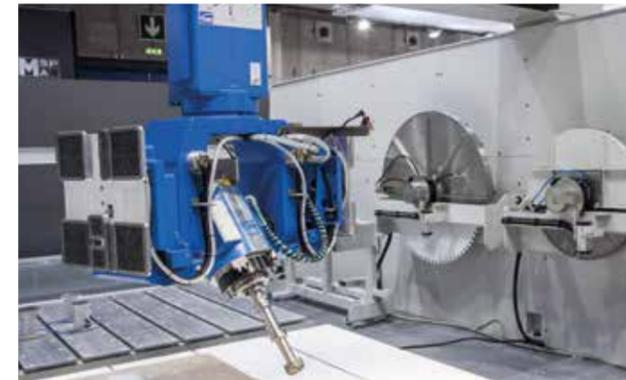
Manipulateur à ventouses avec une portée jusqu'à 1 000 Kg, pour le déplacement des pièces, même de forte épaisseur.
