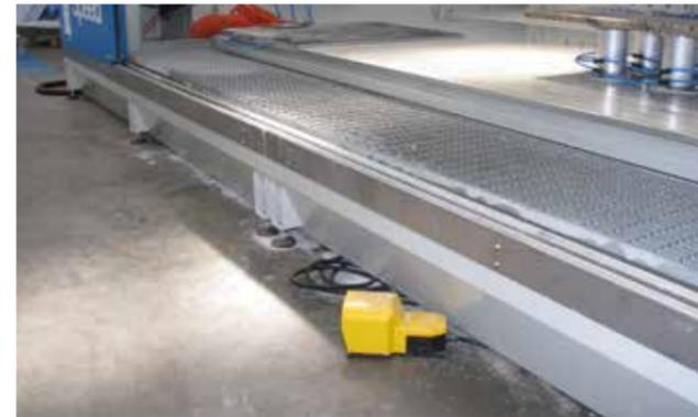
Vasca frontale per ricircolo acqua di lavorazione, completa di piano in grigliato per garantire un facile accesso in macchina all'operatore.
