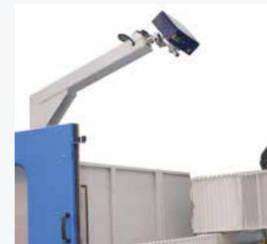
Proiettore laser per posizionamento ventose.
