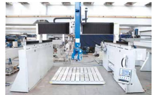
Asse Z fino a 2.000 mm, per garantire la lavorazione di pezzi di altissimo spessore
