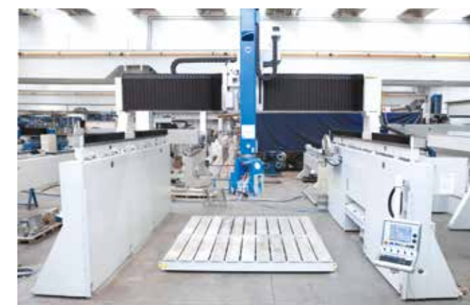
Eixo Z até 2 000 mm para garantir a laboração de peças de altíssima espessura.
