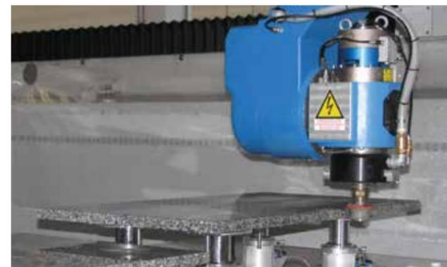
Preajuste láser para la medición automática de la longitud o el diámetro de las herramientas; su uso evita operaciones de ajuste manual y garantiza un control muy preciso de su desgaste.
