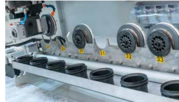
Juego de herramientas para cortar el orificio del fregadero a 90 ° y pulir su borde interno, equipado con cargador.
