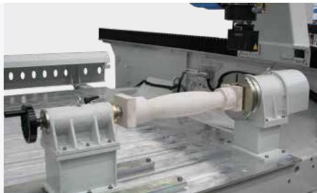
Robusto electromandril de 30 kW que garantiza la potencia necesaria para el procesamiento de bloques de piedra de gran grosor.
