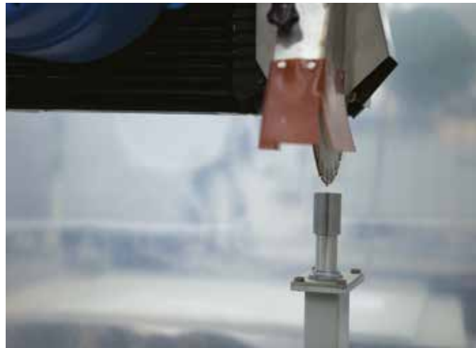
Устройство для измерения диаметра пильного диска и длины сверла.
