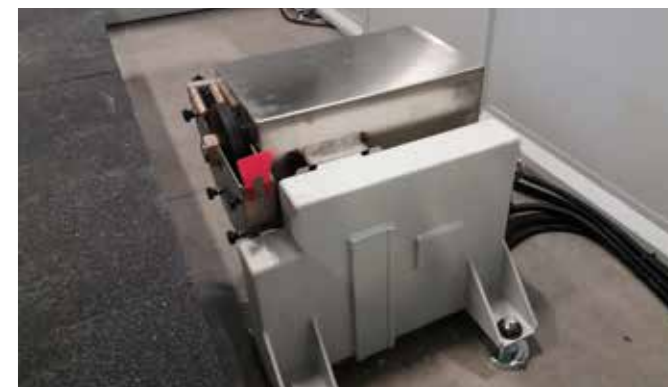
Узел подрезки нижней части слэба, для гравировки нижней стороны плиты; Позволяет вставлять опоры столешнице. Может оснащаться сверлильным устройством для выполнения отверстий для крепления столешниц на кухне / в ванной. Операции управляются автоматически и требуют использования вакуумного манипулятора.
