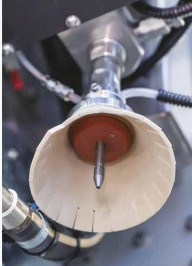
ELEKTRONISCHE DOSIEREINHEIT zur automatischen Kontrolle der Abrasivzufuhr. Wenn der Schleifmittelfluss aus irgendeinem Grund unterbrochen wird, stoppt das System den automatischen Schneidvorgang und verhindert somit Beschädigungen des Werkstückes. Mit der Anbringung eines Vakuumsensors an der Mischkammer wird der dauerhafte Zufluss des Abrasivmittels überwacht und dadurch der schadenfreie Betrieb der Anlage gewährleistet
