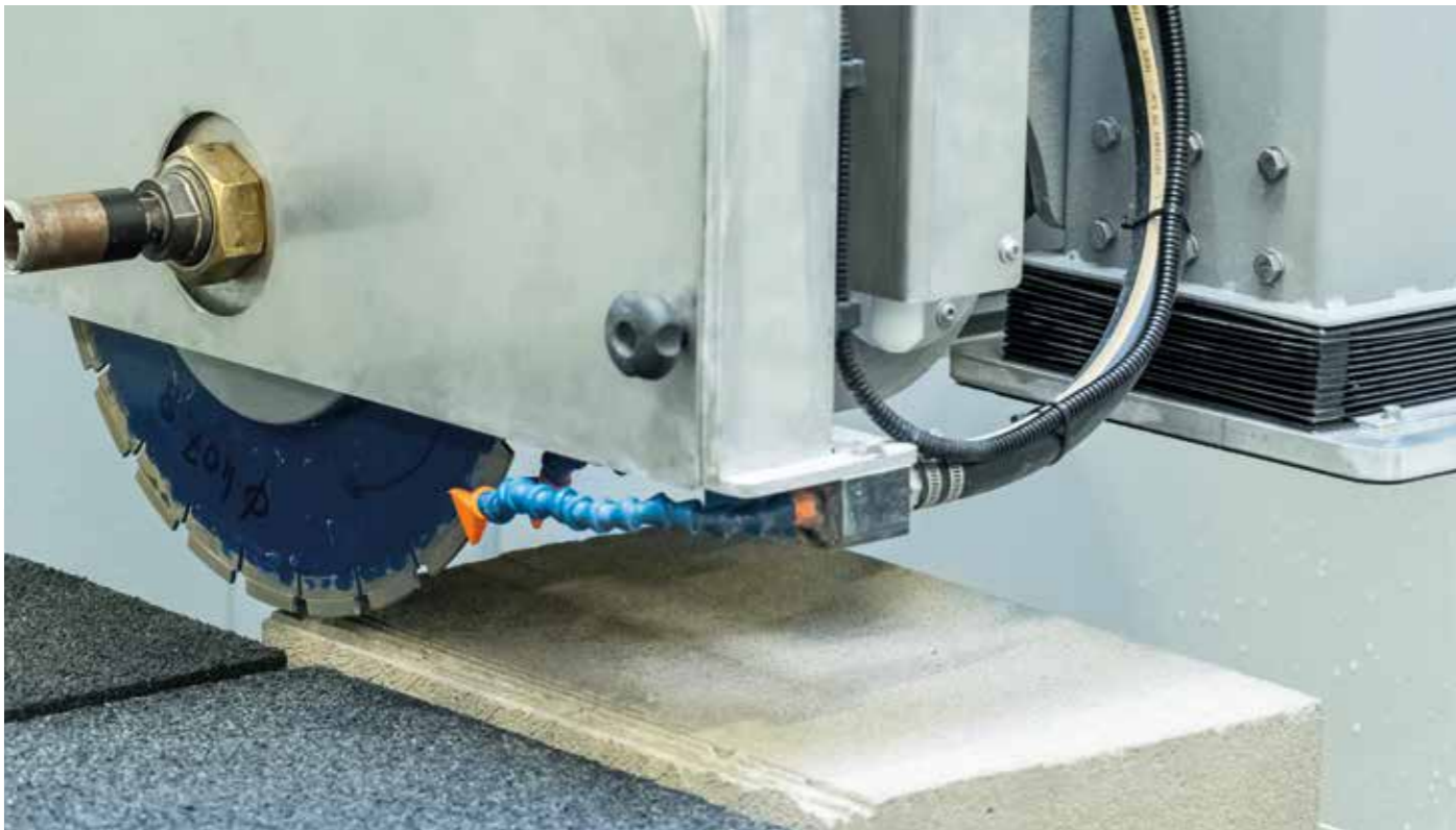
STATION DE REDEMARRAGE AUTOMATIQUE DU DISQUE, activé par une fonction spécifique sur le tableau de l'opérateur
