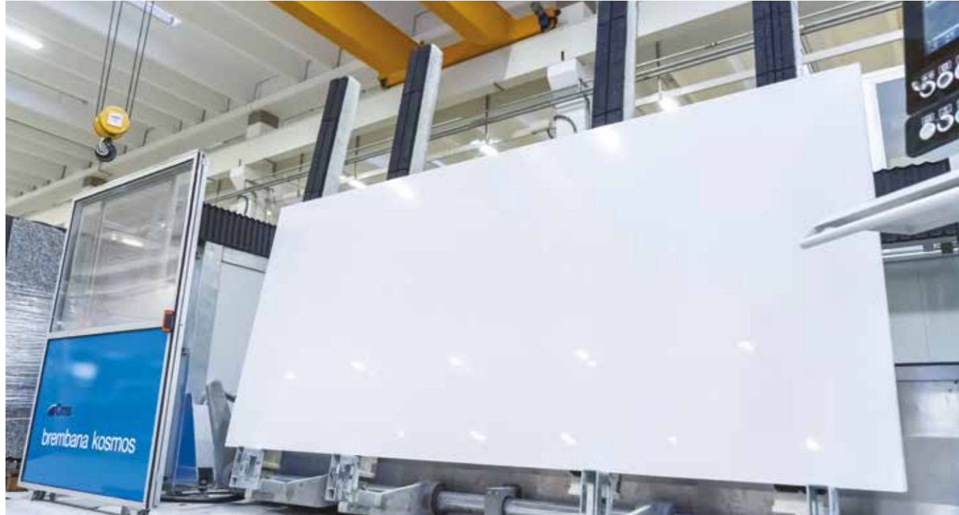
РАБОЧАЯ ИИЙ СТОЛ с 4-мя наклонными вилами (опция, максимальная грузоподъемность до 800 кг) и размерами 4000 x 2350 мм; поверхность рабочего стола из ректифицированной резины
