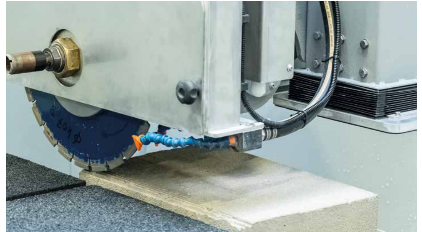
STATION DE REDEMARRAGE AUTOMATIQUE DU DISQUE, activé par une fonction spécifique sur le tableau de l'opérateur
