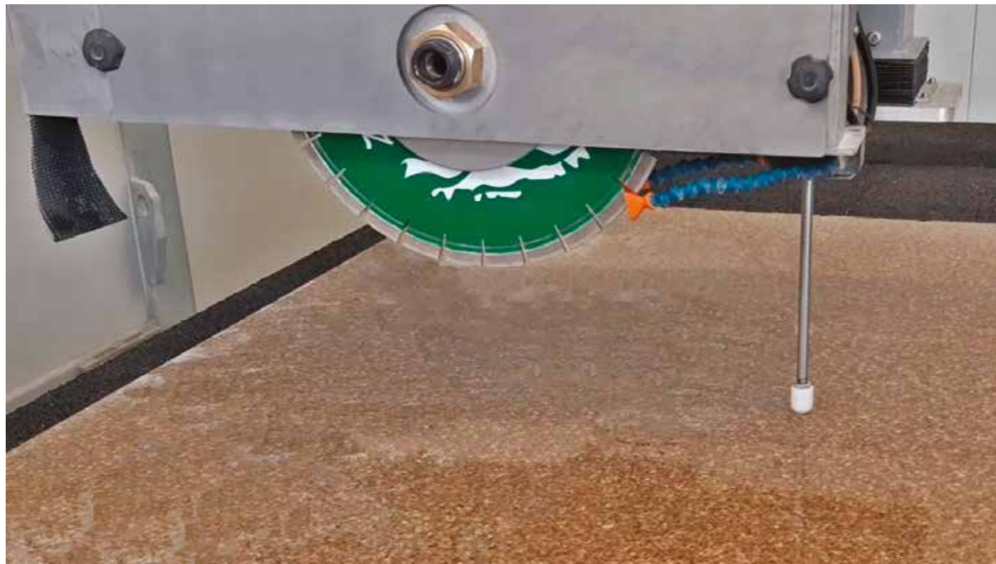
PALPEUR DE L'ÉPAISSEUR DES PLAQUES pour le relevé automatique de l'épaisseur de la pièce
