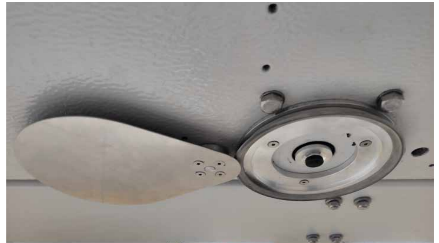
CAMERA: système pour obtenir des images de la table d'usinage, permettant d'accélérer le positionnement des pièces et relever d'éventuels défauts sur le bloc
