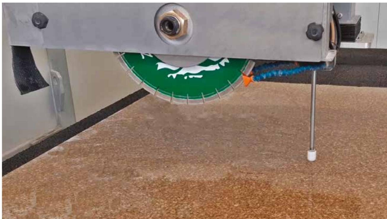
ДАТЧИК ТОЛЩИНЫ ПЛИТ для автоматического измерения погрешностей толщины детали
