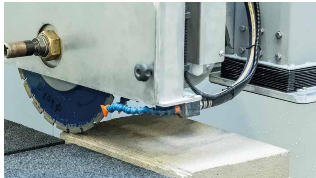
СТАНЦИЯ АВТОМАТИЧЕСКОЙ ПРАВКИ ШЛИФОВАЛЬНОГО ДИСКА, включаемая с помощью специальной функции на панели оператора
