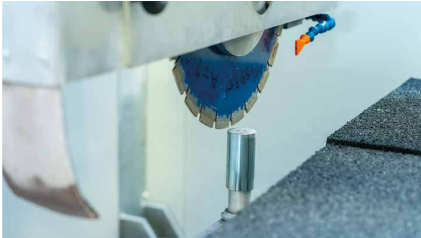
SISTEMA DE PREAJUSTE DE DISCO para medir el diámetro del disco y la longitud de las fresas/sierras
