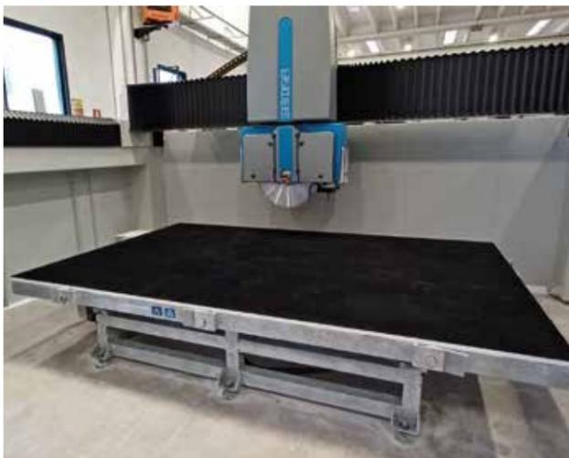
Mesa de trabajo, fija o basculante, protegida contra la corrosión mediante galvanizado en caliente, con superficie de trabajo de caucho o alfombrilla de corte, que puede combinarse con extensiones opcionales para permitir el desplazamiento de las piezas en caso de cortes interferentes.
