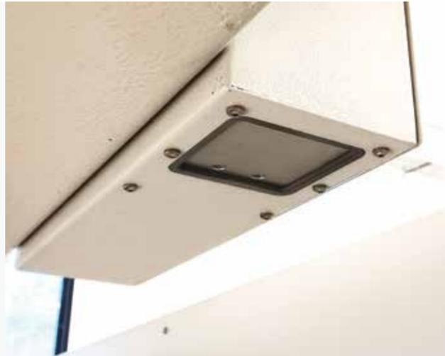
Unidad de rebaje para realizar incisiones en la cara inferior de la losa y poder insertar refuerzos para las encimeras de cocina. Ampliable también con unidad de perforación desde abajo, para la realización de agujeros ciegos dedicados a fijaciones para encimeras de cocina/baño. Las operaciones las realiza automáticamente la máquina y requieren el uso del manipulador de ventosas.
