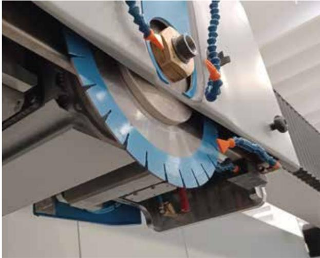
Electrohusillo controlado por inversor que permite ajustar el nº de revoluciones de 0 a 6.000 rpm. Permite utilizar herramientas de diamante como fresas verticales o brocas. El cambio de utillaje es manual.
