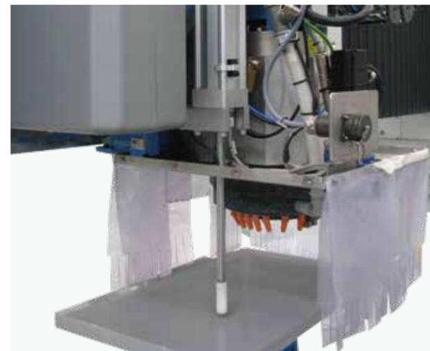
Измерительный щуп за счет определения реальной толщины каменной или керамической плиты гарантирует безупречное исполнение обрабатываемого элемента.
