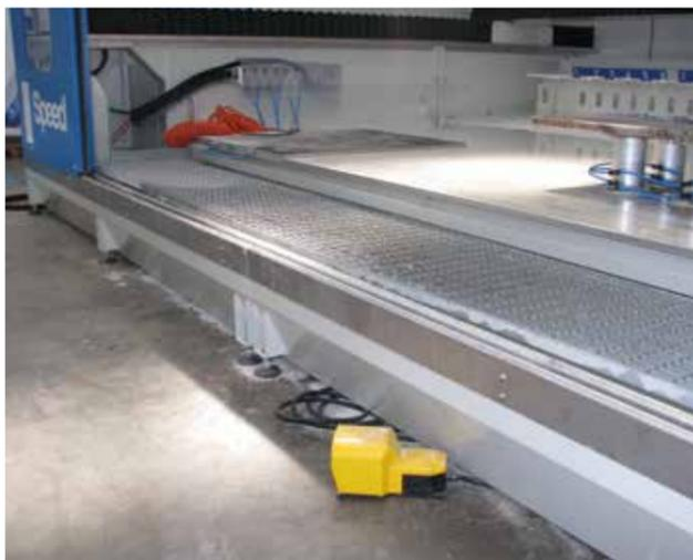
Передняя ванна для рециркуляции рабочей воды, оснащенная решетчатой поверхностью для обеспечения оператору легкого доступа к машине.
