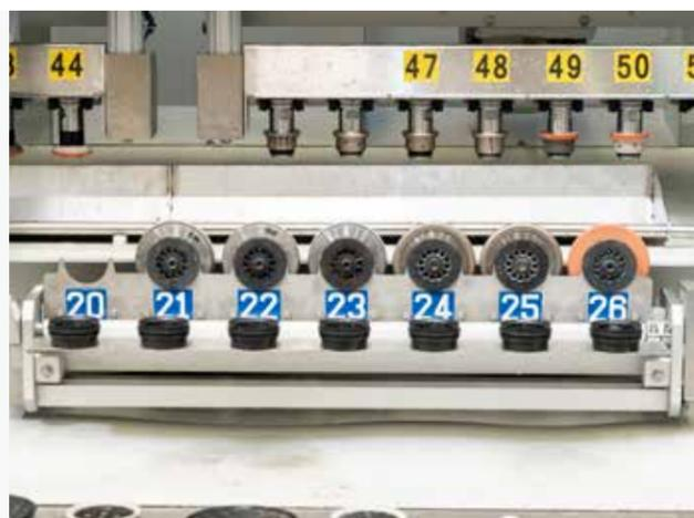
Блок резки 90° для вертикальных дисков.
