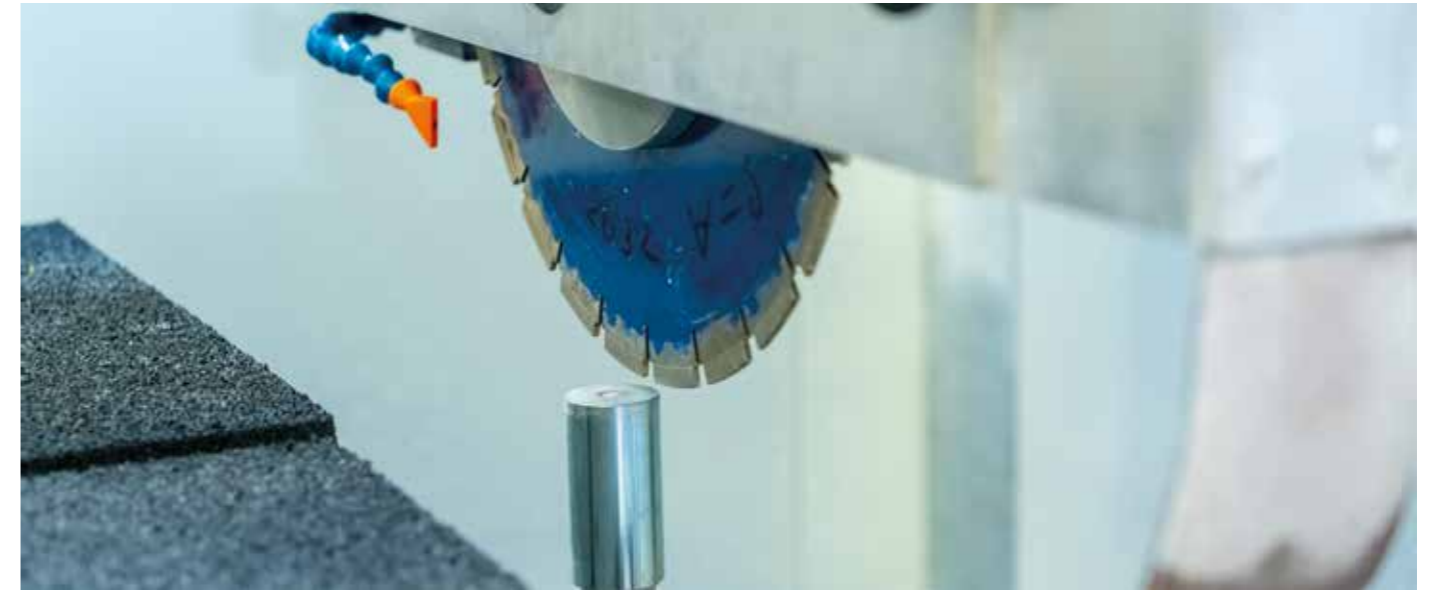
WERKZEUGVERMESSUNG zur automatischen Erfassung des Durchmessers des Sägeblattes oder der Länge von Bohrern oder Fräsern
