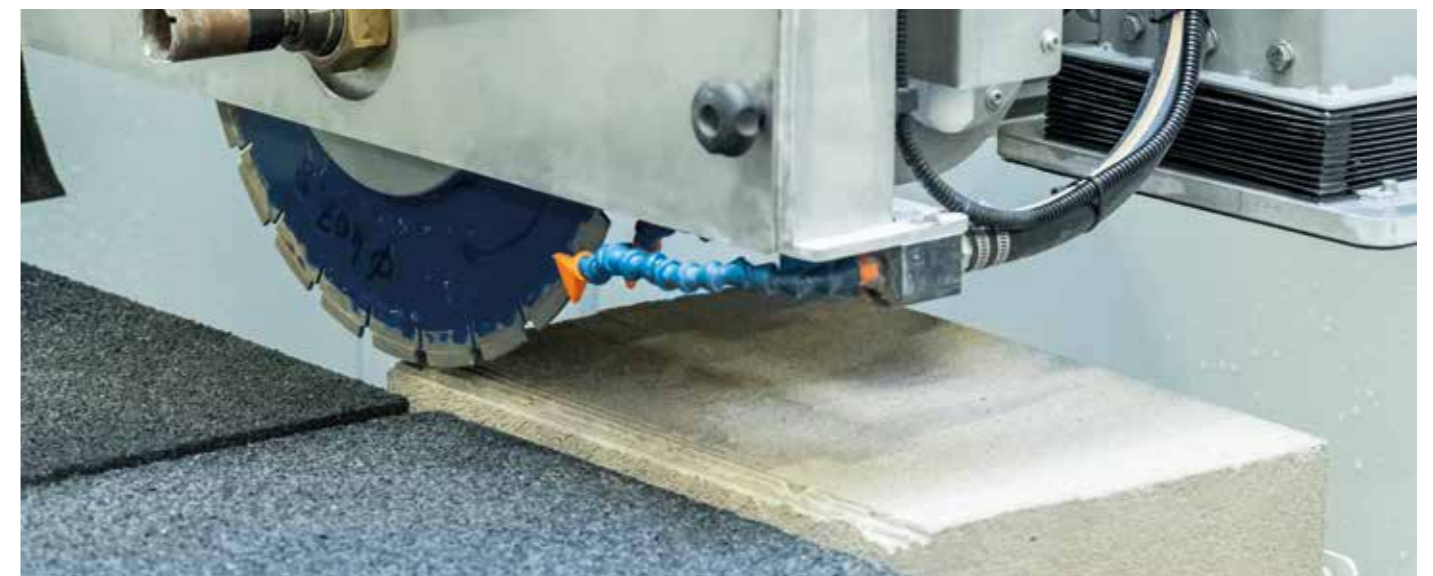
STATION DE REDEMARRAGE AUTOMATIQUE DU DISQUE, activé par une fonction spécifique sur le tableau de l'opérateur
