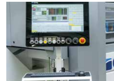
用于管理水射流切割系统的硬件和软件旨在为操作员提供简单直观的操作界面，用以全面管理系统的所有功能，包括5轴机床的锥度补偿 (JDC)。
