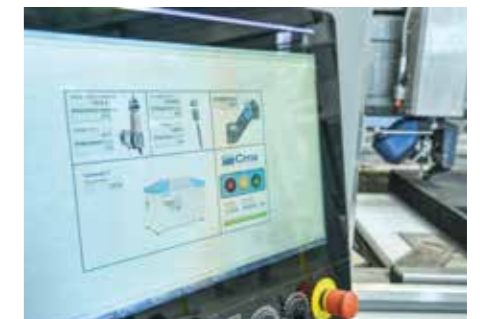
用于管理水射流切割系统的硬件和软件旨在为操作员提供简单直观的操作界面，用以全面管理系统的所有功能，包括5轴机床的锥度补偿 (JDC)。
