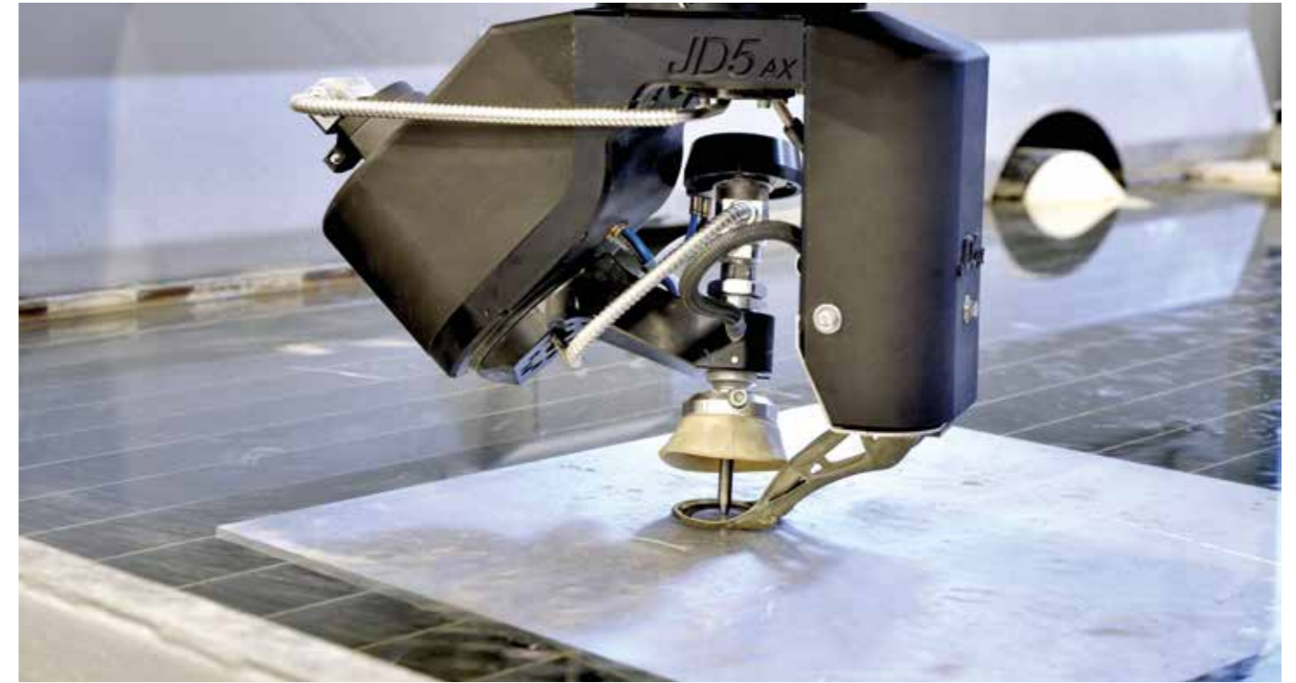
水位 底座内有一个水位自动调节系统。凭借压缩空气的辅助可以将槽内水位增加至50mm，从而允许浸没切割加载于切割平面上的材料，保证降低工作环境内的噪音和水混响。底座内安装的传感器可以准确将水位定位在工件表面上，无需操作员干预。
