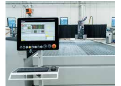
21.5英寸触屏控制台,位于活动滑架上。
