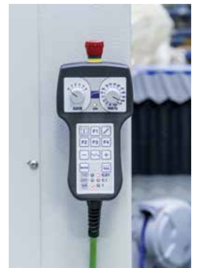
Fernbedienfeld für die Steuerung von bis zu 6 Achsen, für die Arbeit in der Nähe des Schneidtisches und die Einstellung von Mehrfach-Ursprungspunkten.
