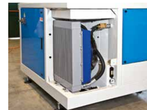
Scambiatore di calore aria/olio
