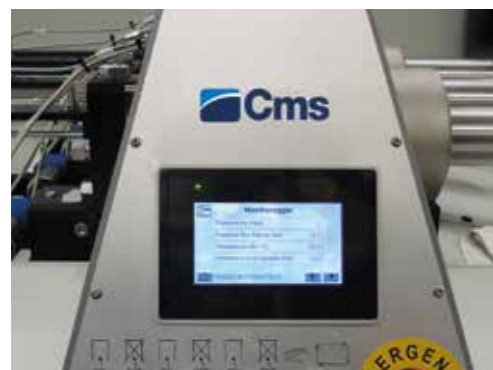
Controllo elettronico della pressione di taglio
