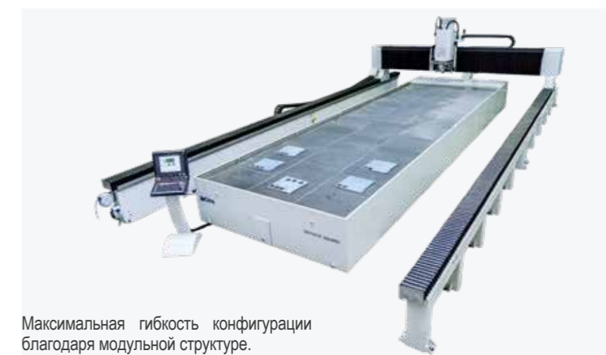
Выносной пульт для управления до 6 осями, которая позволяет работать вблизи стола резки и устанавливать несколько исходных точек.
