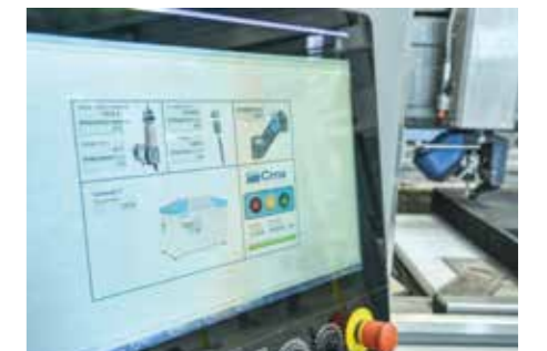
Hardware y software de gestión del sistema de corte por chorro de agua diseñados para ofrecer una interfaz con el operador sencilla e intuitiva y permitir una gestión completa de todas las funciones del sistema, incluido el control de la conicidad (JDC) para máquinas de 5 ejes.
