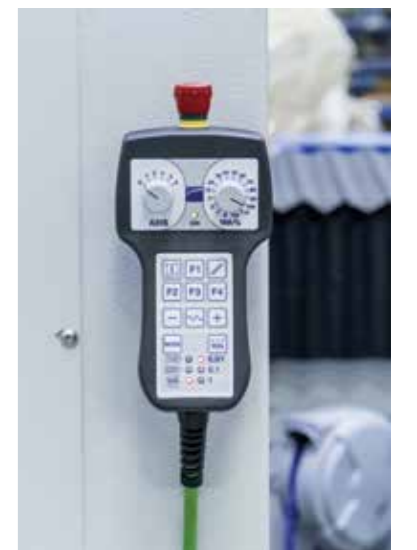
Panel de control remoto para controlar hasta 6 ejes que permite operar cerca de la mesa de corte y configurar los múltiples orígenes.
