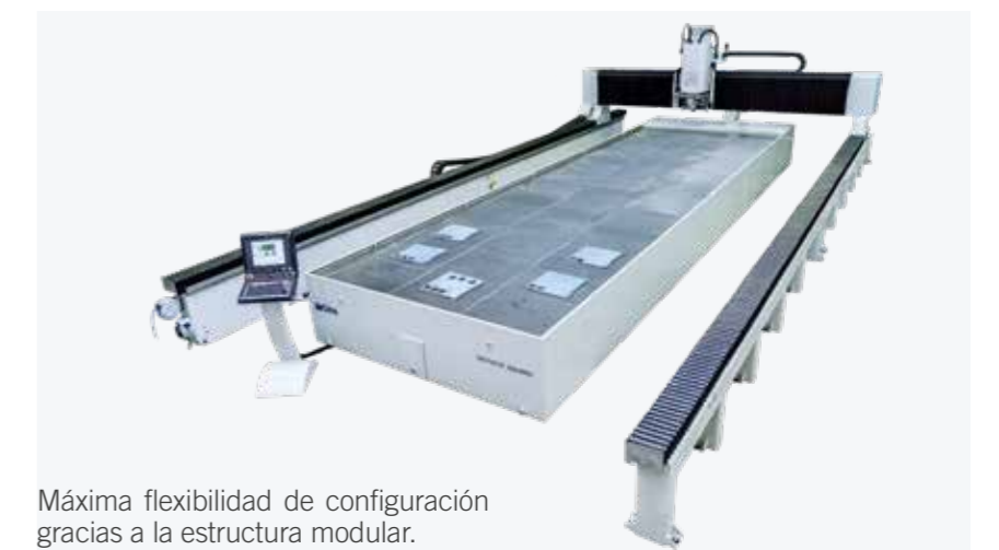
Panel de control remoto para controlar hasta 6 ejes que permite operar cerca de la mesa de corte y configurar los múltiples orígenes.
