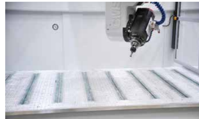
Absaugtisch aus Aluminium mit T-Nuten aus Stahl
