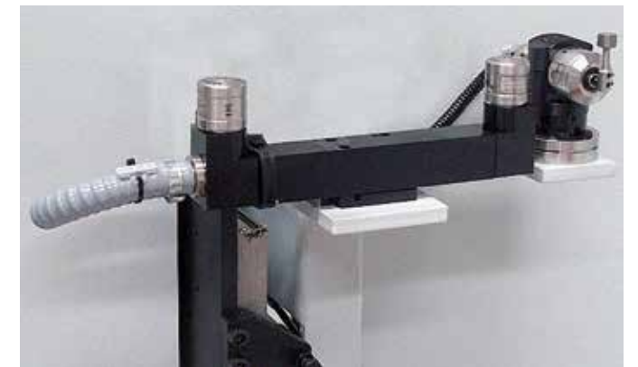
Sistema de realinhamento dos eixos rotativos com laser para medição comprimento e diâmetro das ferramentas
