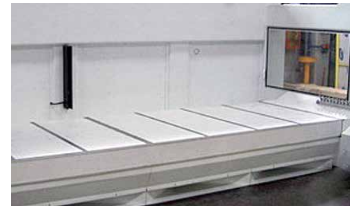
Bocas de aspiração
