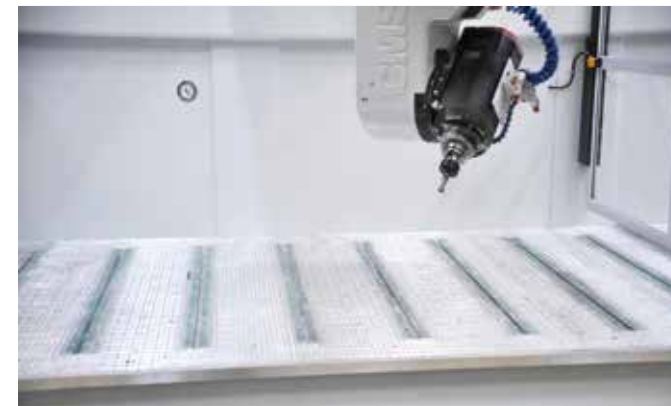
Всасывающий стол из алюминия со стальными Т-образными пазами
