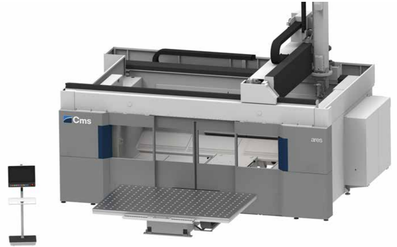
Ares 配备单个可抽出工作台 1APC (自动托盘更换)
