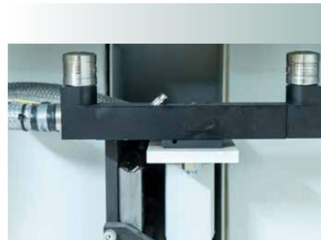
Lasengerät zur Messung von Werkzeugdurchmesser und -länge
