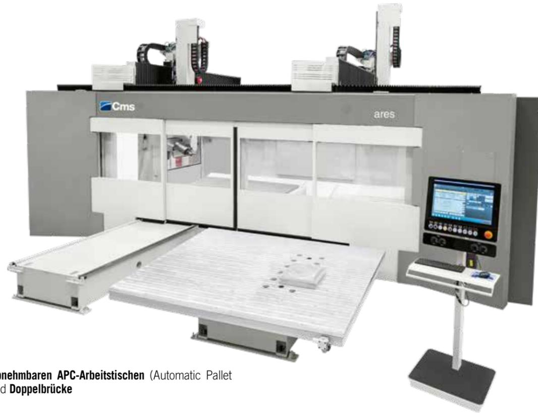
Ares mit abnehmbaren APC-Arbeitstischen (Automatic Pallet Change) und Doppelbrücke
