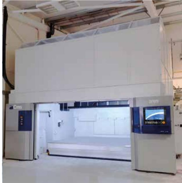
Integrierte Schallschutzkabine zur Staubeindämmung, komplett mit Innenbeleuchtung
