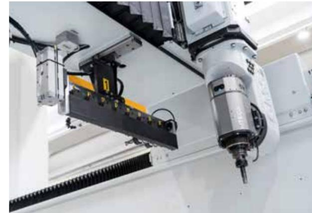
Werkzeugwechslermagazin unter der Traverse
