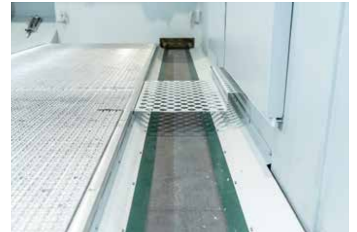
Bande transporteuse pour l'évacuation des copeaux
