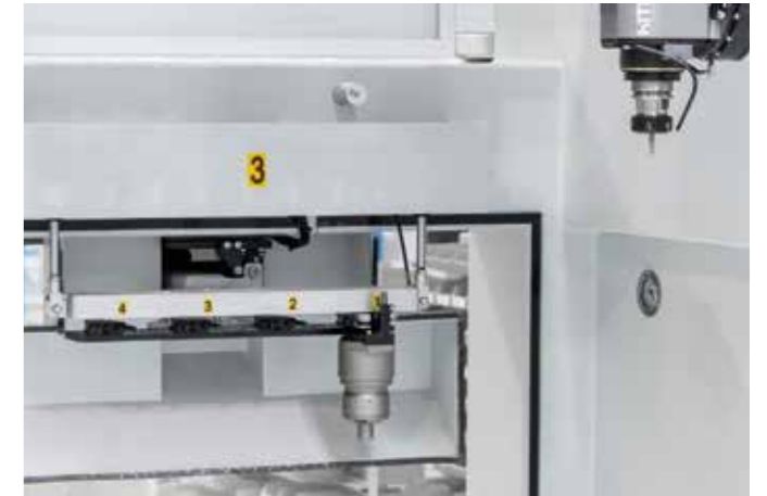
Magazzino pick-up laterale
