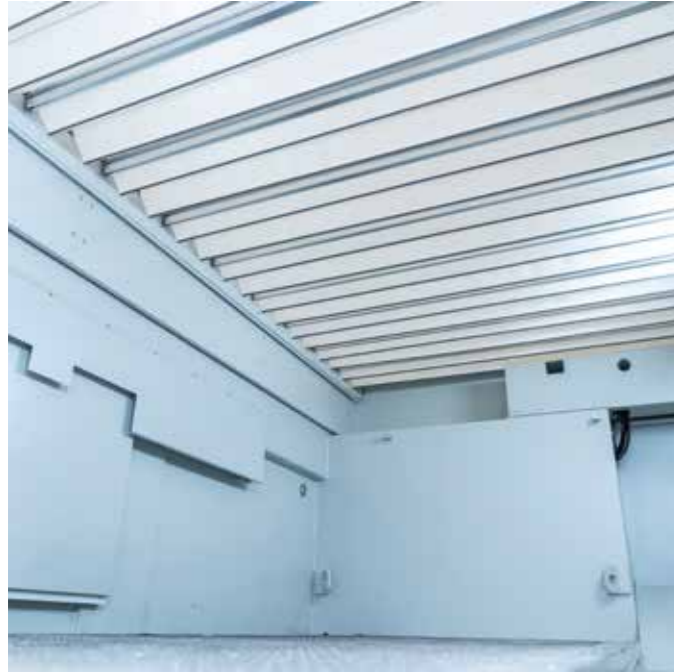
Copertura a soffietto che limita la fuoriuscita di fumi, polveri e trucioli dall'area di lavoro
