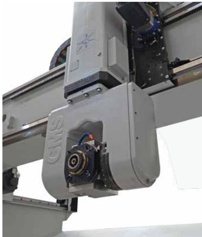
UNIDADE OPERACIONAL HX5
