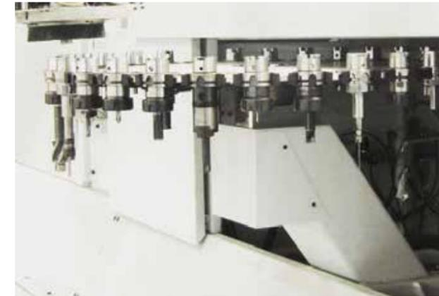
Automatisches Dreh-Werkzeugmagazin mit 30 Stationen
