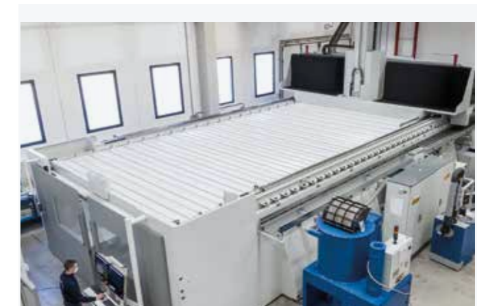
Verschluss auf der Oberseite mit Faltenbalg für die Auffangung von Staub und Spänen
