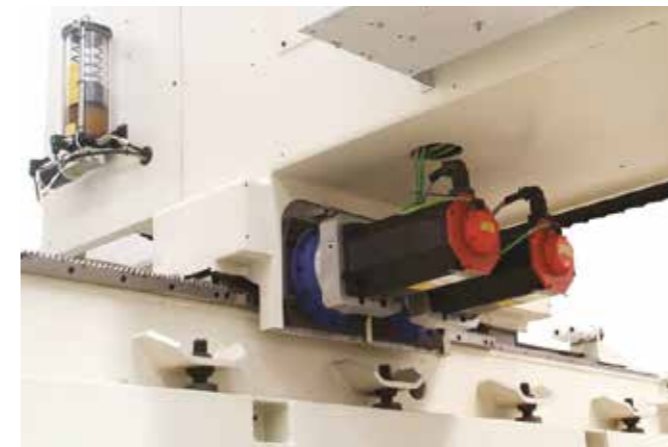
Cinématique avec récupération du jeu électrique (double moteur) pour assurer une plus grande rigidité et précision
