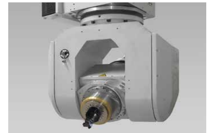
FX5 unità a forcella con doppia motorizzazione torque
