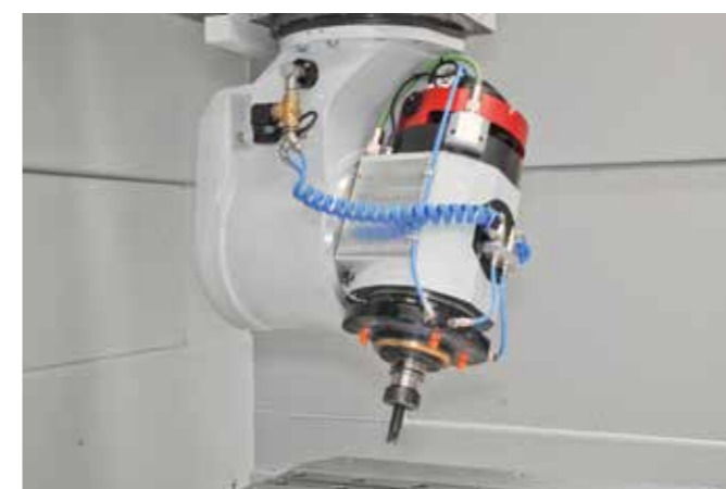
5-осевая режущая головка с технологией прямого привода
