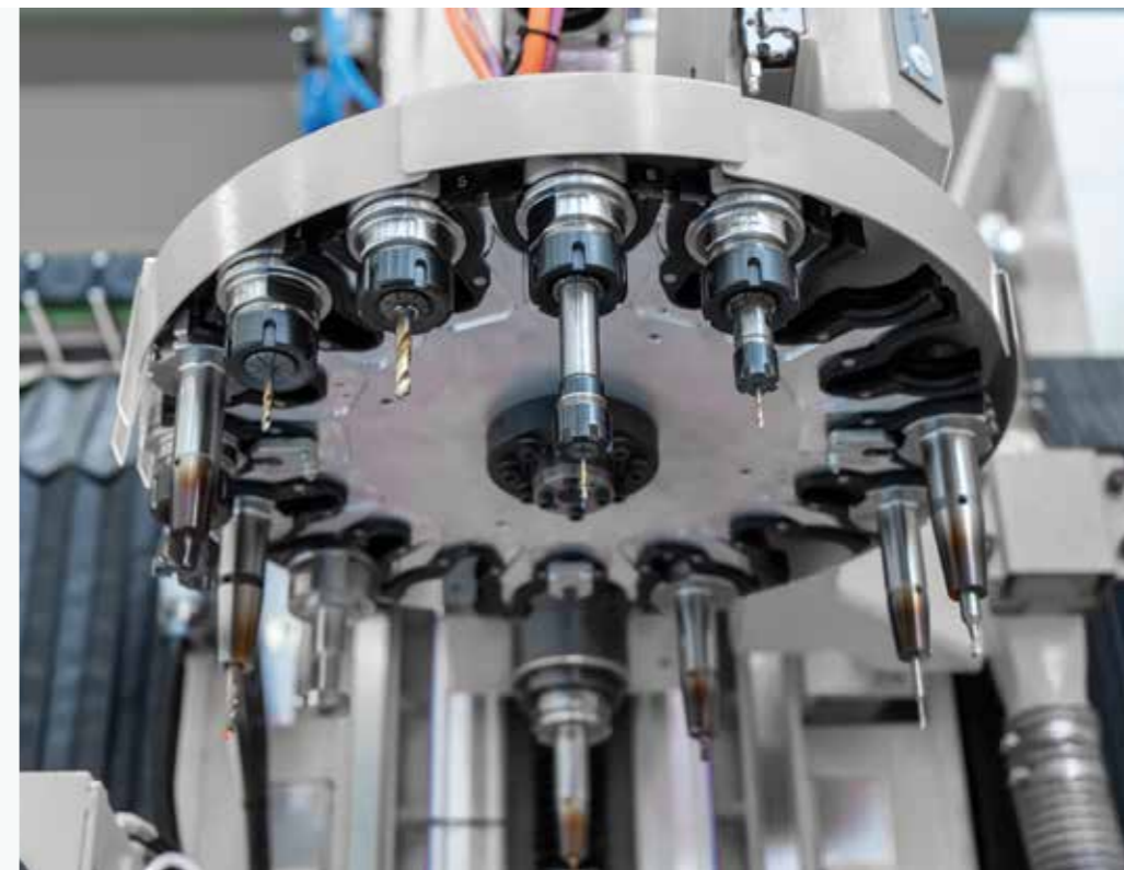
MAGAZZINI A DISCO I magazzini a disco, imbarcati o a lato del ponte, possono ospitare da 8 a 16 utensili.
