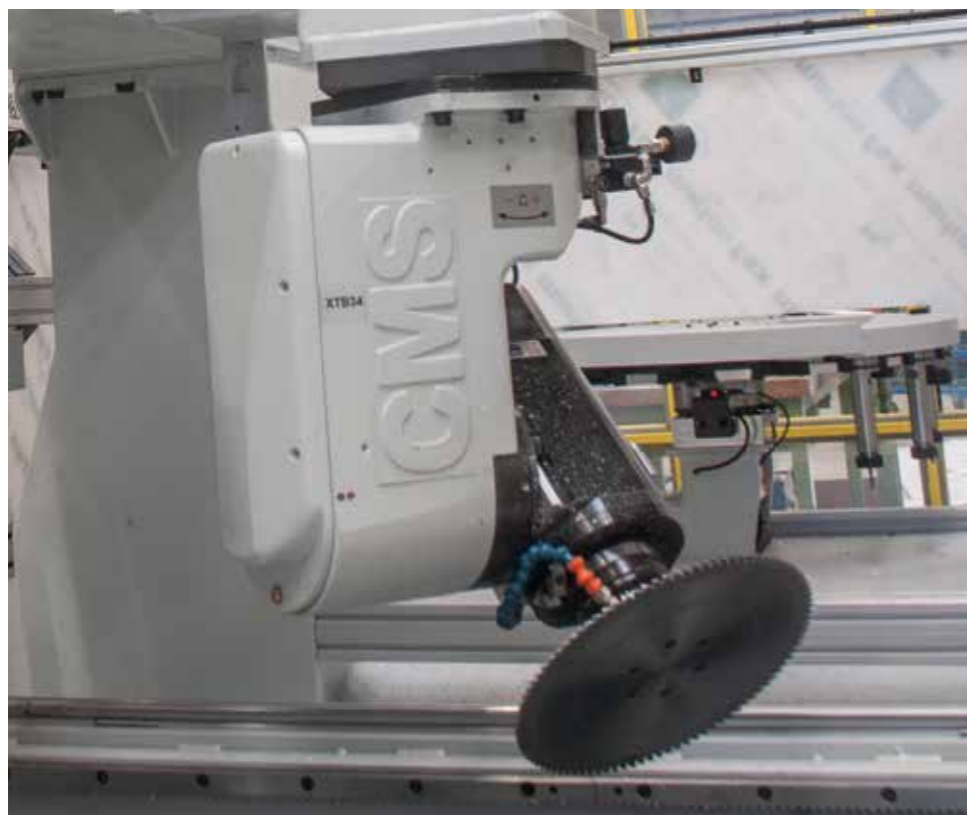
PX5 Unità a 5 assi con mandrini da 12 a 20 kw, sistema di raffreddamento e lubrificazione con passaggio interno alla punta dell'utensile e freni pneumatici.
