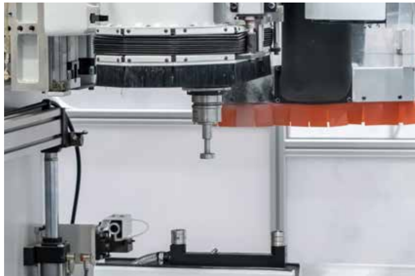
RIQUALIFICHE Sono disponibili riqualifiche, a contatto o laser, per la calibrazione degli assi e la misurazione dei diametri e lunghezze degli utensili.
