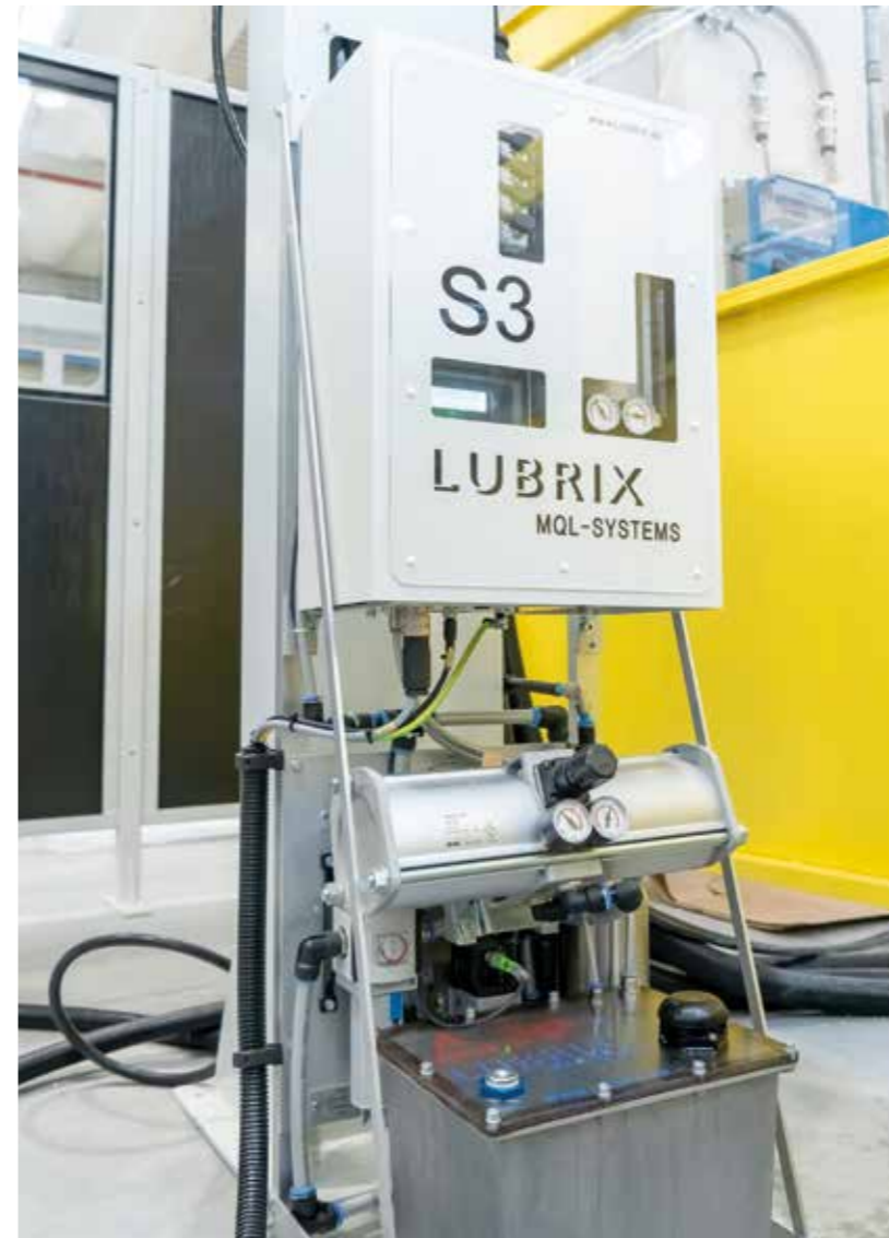
SISTEMI MQL Massima efficacia con il minimo consumo di lubrificante. I sistemi MQL, in associazione con elettromandri che permettono il passaggio aria/olio interno all'utensile , garantiscono una lubrificazione perfetta anche in situazione critiche.
