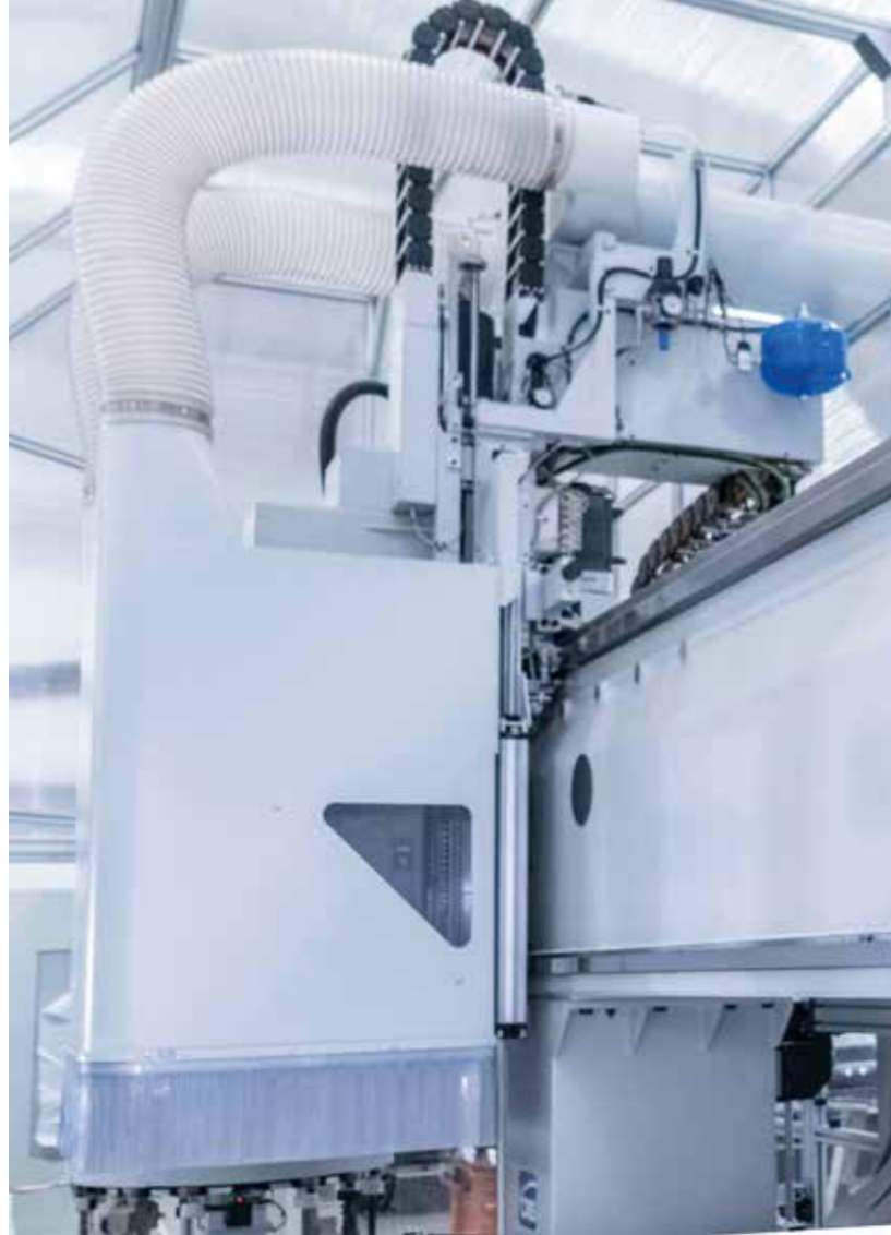
CAPPA D'ASPIRAZIONE CONTROLLATA DA CN Quando la macchina è equipaggiata con unità operatrice a 5 assi PX5, è possibile prevedere una cappa di aspirazione polveri da lavorazione, controllata dal CN.
