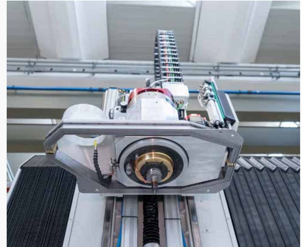
PX3 - KX3 Unidades operadoras para configurações de 3 ou 4 eixos, com mandris de 12 a 32 kW a 24.000 rpm.
