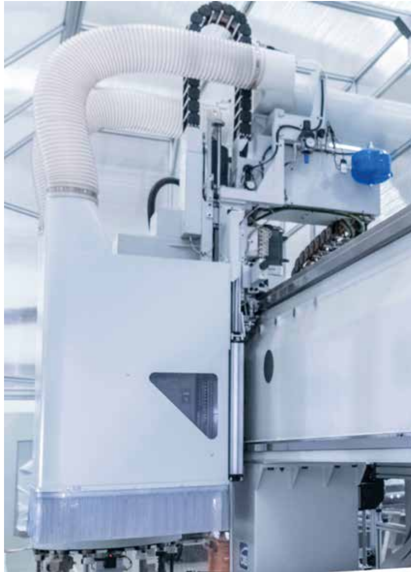
COIFA DE ASPIRAÇÃO CONTROLADA POR CN Quando a máquina está equipada com a unidade operadora de 5 eixos PX5, é possível fornecer uma coifa de aspiração de poeiras para processamento, controlado pela CN.
