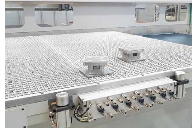
GRUPOS DE DISTRIBUIÇÃO DE AR/VÁCUO Para utilizar garras, ventosas ou sob peças específicas.
