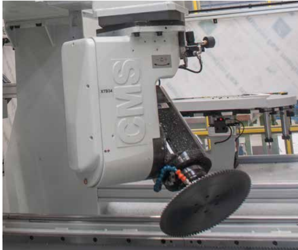
PX5 Unidade com 5 eixos com mandris de 12 a 20 kw, sistema de refrigeração e lubrificação com passagem interna na ponta da ferramenta e travões pneumáticos.
