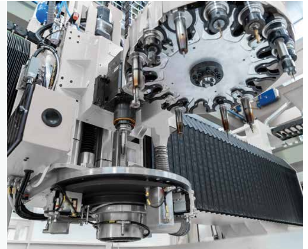
UNIDADE STACK Dispositivo para o processamento de chapas metálicas, combinado com mandris de 12, 15 ou 20 kW refrigerados a líquido e equipados com uma passagem interna para MQL.
