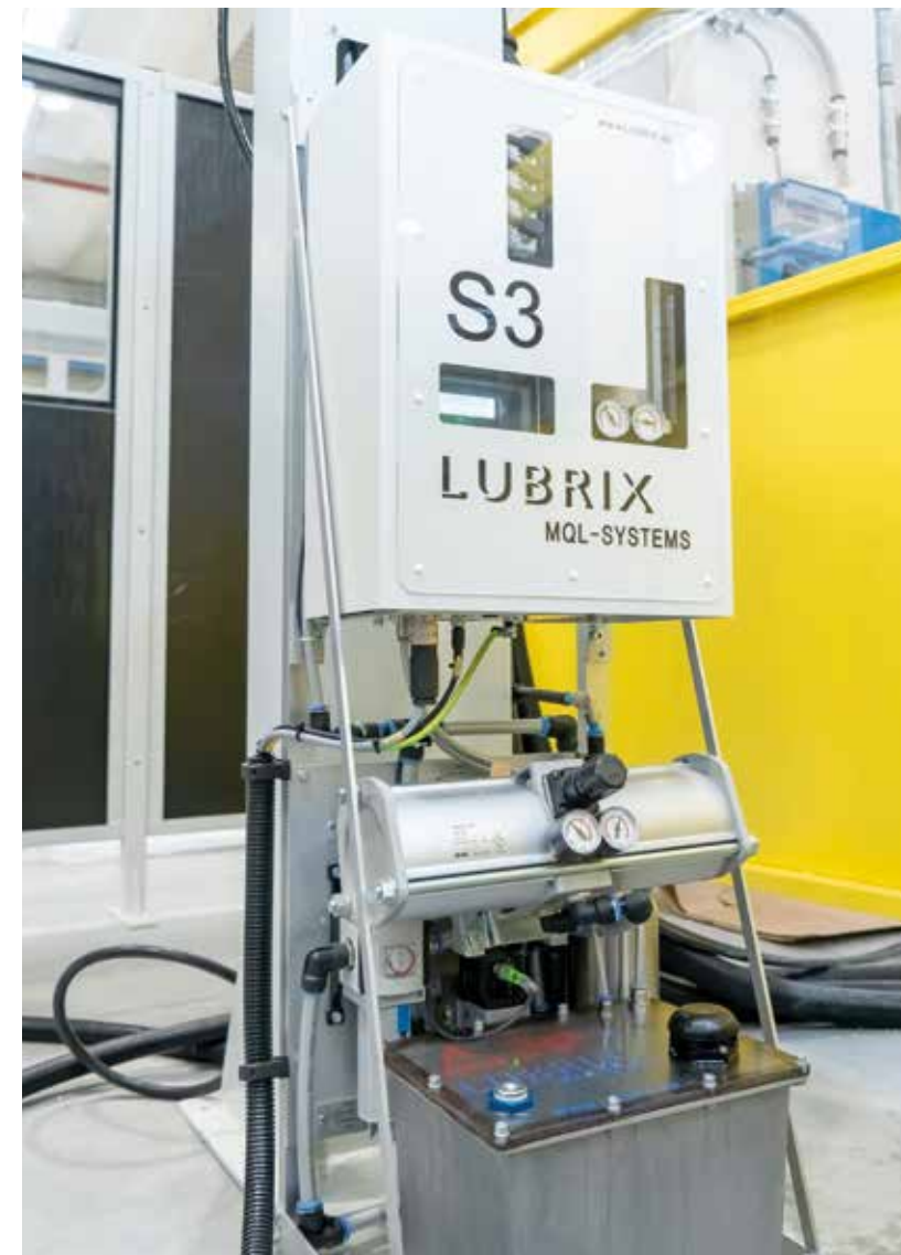
SISTEMAS MQL Máxima eficiência com consumo mínimo de lubrificante. Os sistemas MQL, em associação com os electromandris que permitem a passagem de ar/óleo no interior da ferramenta, garantem perfeita lubrificação mesmo em situações críticas.
