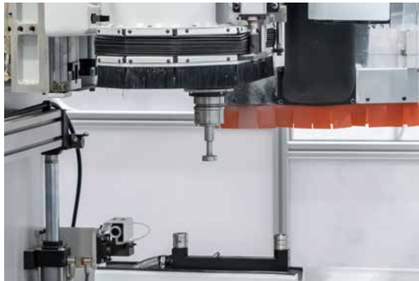
REQUALIFICAÇÕES Estão disponíveis requalificações, de contacto ou a laser, para a calibração dos eixos e a medição dos diâmetros e comprimentos das ferramentas.
