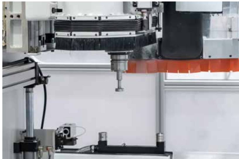
RECALIFICACIONES Se encuentran disponibles recalificaciones, por contacto o láser, para la calibración de los ejes y la medición de los diámetros y longitudes de las herramientas.
