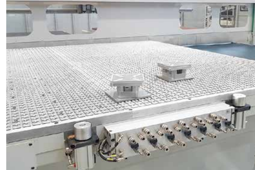
GRUPOS DE DISTRIBUCIÓN DE AIRE/VACÍO Para utilizar pinzas, ventosas o subpiezas específicas.
