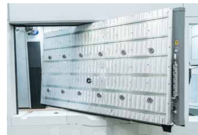
工作台面 工作台面可根据客户需求定制（零点、真空、T型槽...等）
