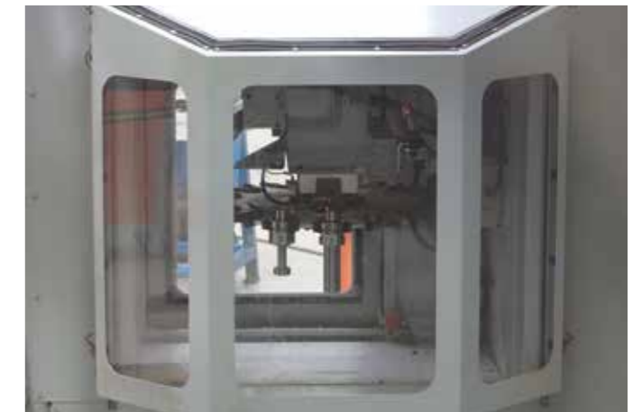
WERKZEUGMAGAZIN Sicherer, staubgeschützter Zugang
