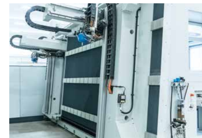
КАБИНА Интегрированная кабина с сиффонами полностью закрывает рабочую зону
