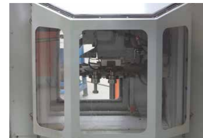
МАГАЗИН ИНСТРУМЕНТА Доступ в полной безопасности и с защитой от пыли
