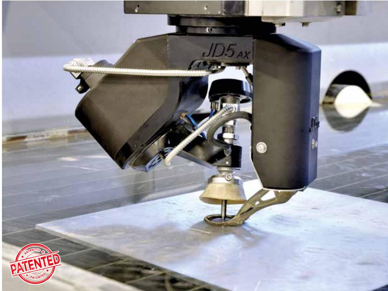
JD5ax的特性开辟了新的切割途径，最大程度地提高了CMS 5轴水射流系统的操作灵活性，并确保了使用水磨水射流切割系统时具有最高标准的质量和精准度。5轴创新头JD5ax 可以实现较低的锥度值，保证精加工高品质和尺寸精度。JD5ax是由一个CMS水射流系列的绝对新品无限旋转轴 (C)、一根可倾斜至 +/- 62°的轴 (B)构成，两者都是完全由CMS设计和制造。
