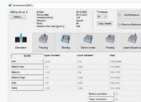
包装内还供应插入式 JDE，用于管理在完整材料数据库中存档的切割技术。机器程序将自动生成，基于5种预期切割品质 (Q1, Q2, Q3, Q4 和 Q5)，决定内/外角的前进速度和加速设置。ISO程序可以通过局域网或USB驱动器转移到机床上。
