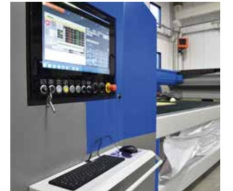
机载21.5英寸工业计算机面板，带触摸屏显示器和HMI CMS Active界面。
