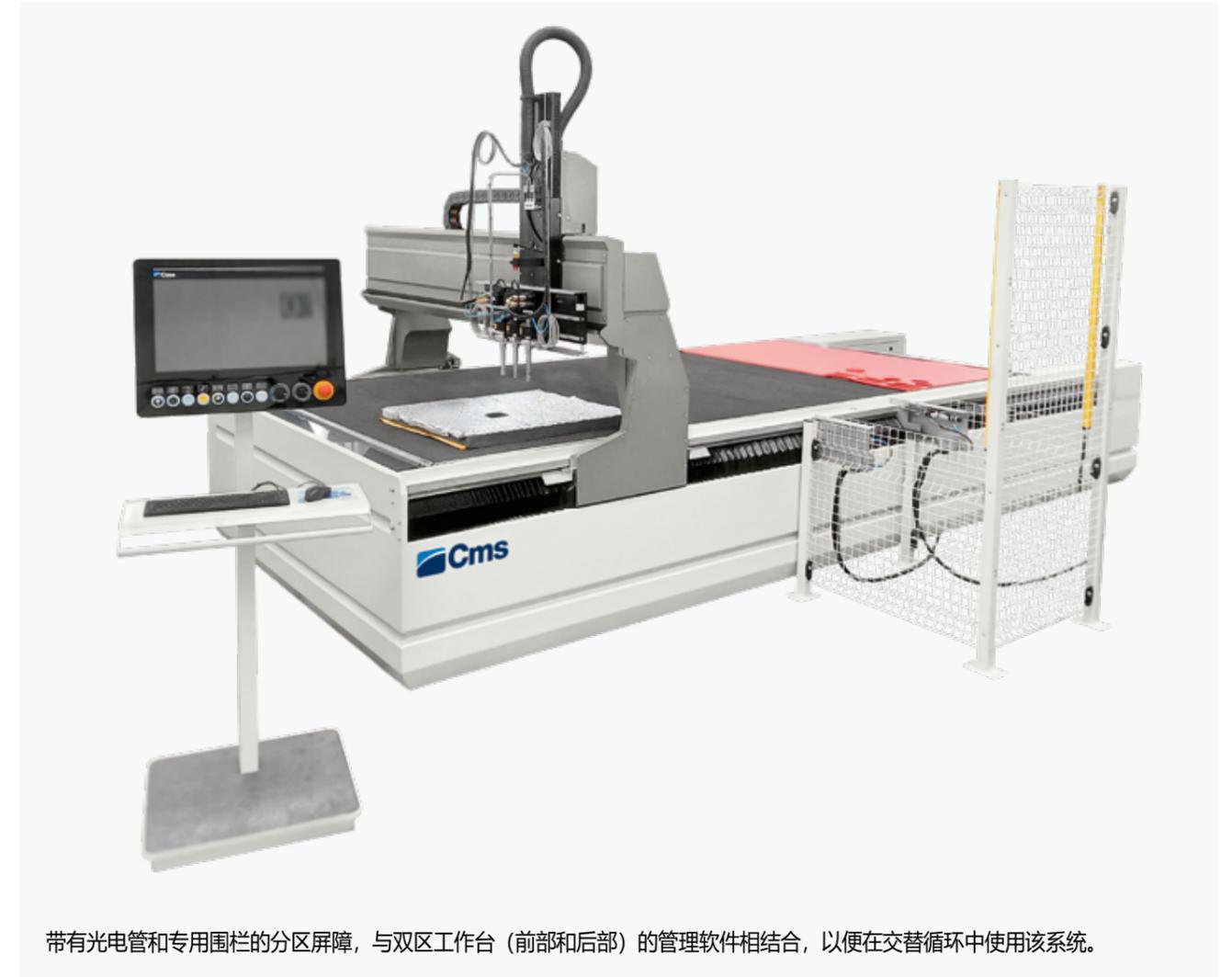
带有光电管和专用围栏的分区屏障，与双区工作台（前部和后部）的管理软件相结合，以便在交替循环中使用该系统。
