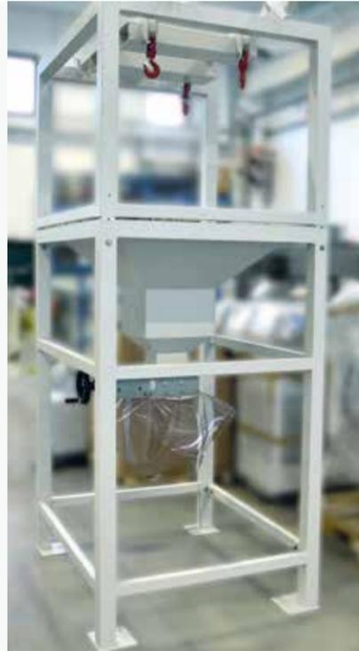
330 kg容积的磨料推进器，用于供应磨料，配备了两个储罐：一个容积为330 kg，另一个受到增压，用于给切割头送料（电子分配器）。还有2000 kg的双级版本，可以完成循环时间长的的工作，避免磨料缺失造成的中断乃至材料受损。
