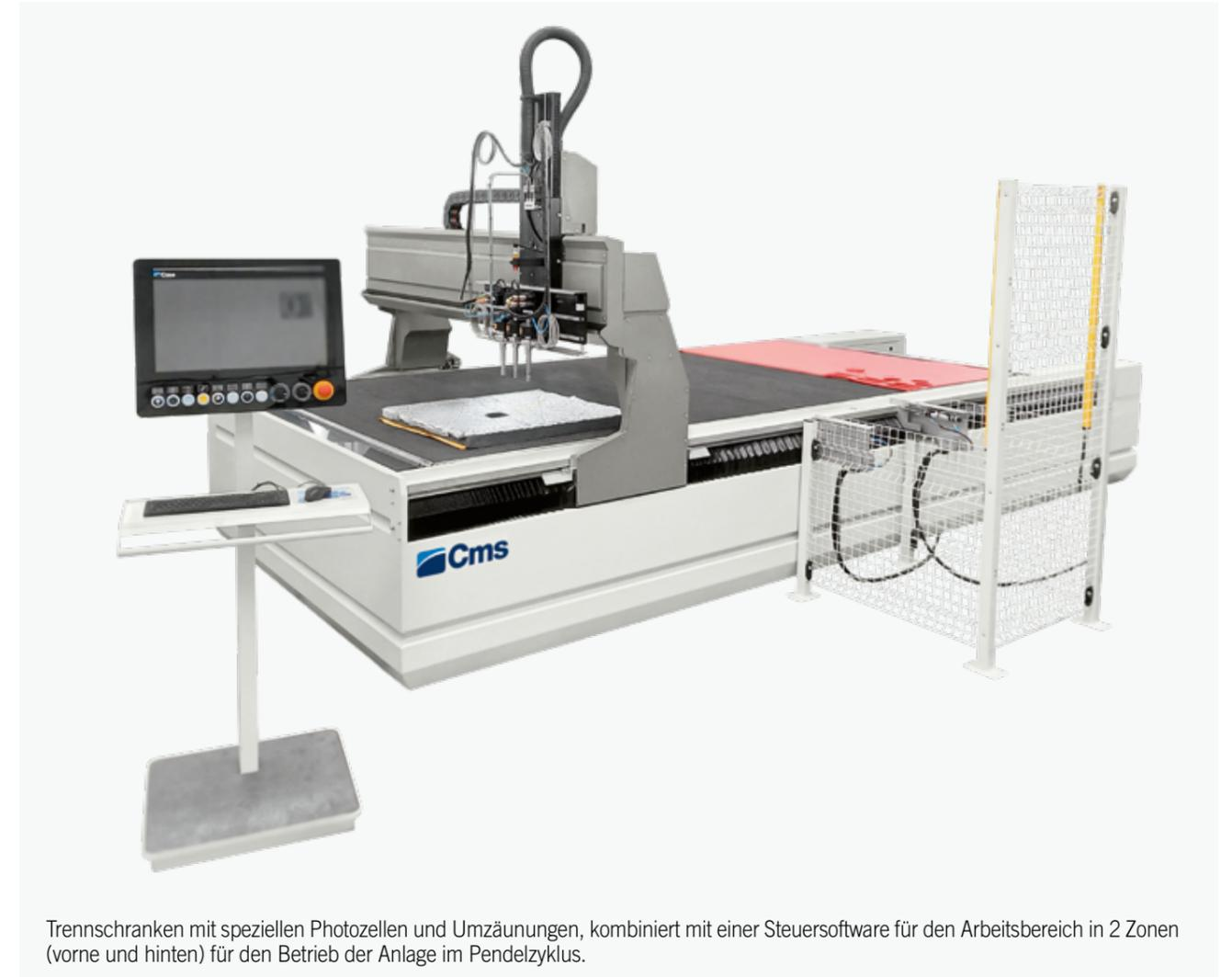
Trennschranken mit speziellen Photozellen und Umzäunungen, kombiniert mit einer Steuersoftware für den Arbeitsbereich in 2 Zonen (vorne und hinten) für den Betrieb der Anlage im Pendelzyklus.
