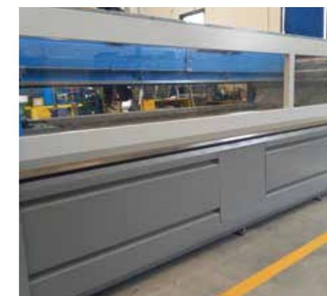
Porte avant et arrière avec mouvement pneumatique pour une meilleure protection de la zone de coupe et confinement de l'eau et des reflats abrasifs.
