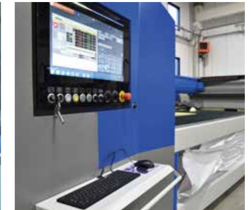
Panneau PC industriel 21,5" sur la machine avec écran tactile et interface HMI CMS Active.
