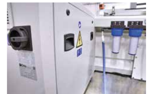
Panneau électrique intégré dans la base du réservoir pour réduire l'encombrement au sol.
