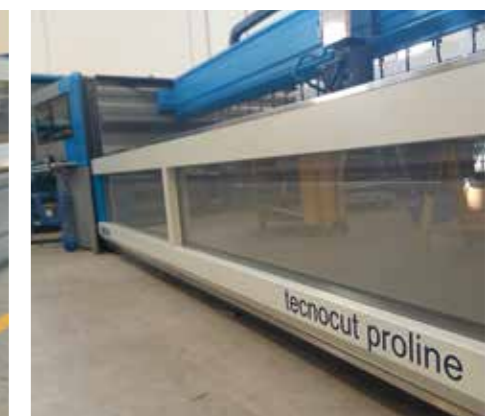
Portella frontale e posteriore con movimento pneumatico per una migliore protezione dall'area di taglio e contenimento dei riverberi di acqua e abrasivo.
