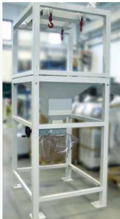
Propulsor abrasivo com uma capacidade de 330 kg para a alimentação do abrasivo equipado com dois reservatórios: um com uma capacidade de 330 kg e outro, pressurizado, para alimentar a cabeça de corte (doseador eletrônico). A versão de 2000 kg em dupla fase também está disponível, o que permite-lhe o término dos trabalhos longos sem interrupções por falta de abrasivo com consequente dano ao material.
