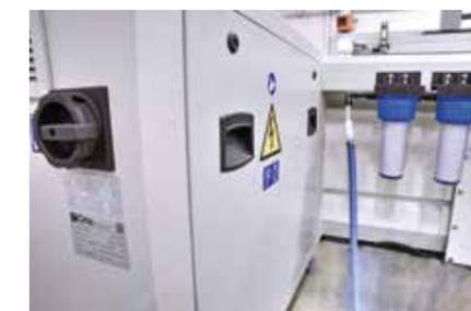
Quadro elétrico integrado na base do tanque para reduzir o espaço no chão.
