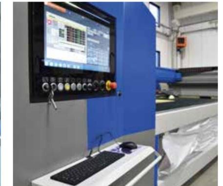
Painel PC Industrial de 21,5" a bordo da máquina com ecrã tátil e interface HMI CMS Active.
