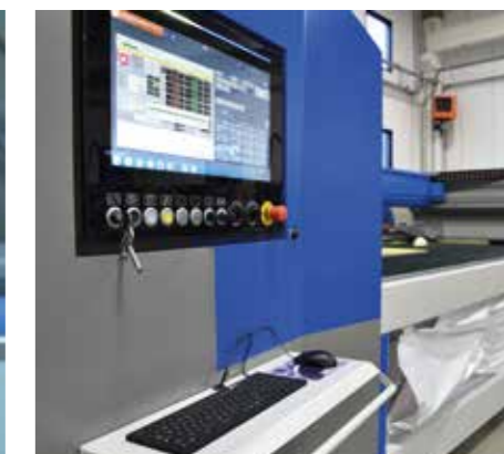
Промышленная панель ПК с диагональю 21,5 дюйма на борту машины с сенсорным дисплеем и интерфейсом CMS Active.
