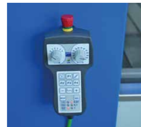
Выносной пульт для управления до 6 осями, что позволяет работать вблизи стола резки и устанавливать несколько исходных точек.
