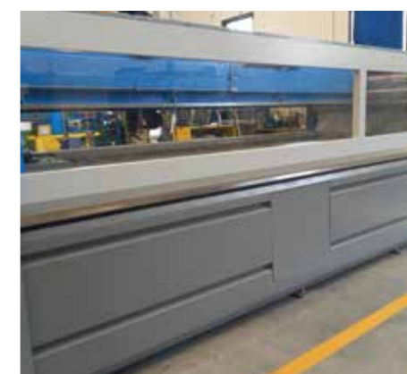
Передняя и задняя дверцы с пневматическим приводом для лучшей защиты зоны резки и сдерживания отражения воды и абразива.
