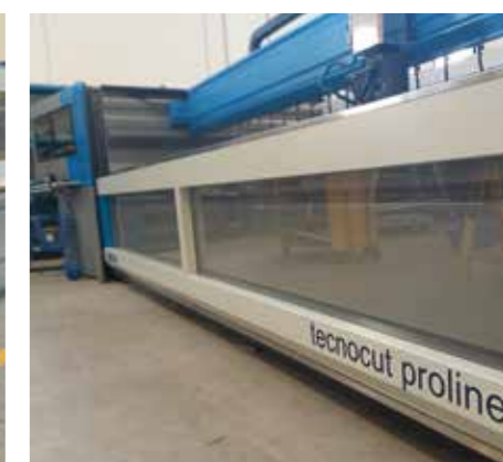
Передняя и задняя дверцы с пневматическим приводом для лучшей защиты зоны резки и сдерживания отражения воды и абразива.
