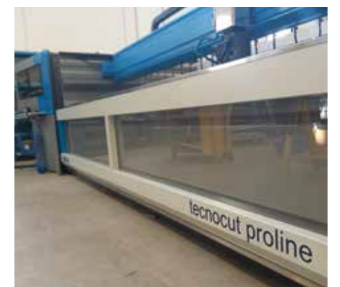
Puerta delantera y trasera con movimiento neumático para una mejor protección de la zona de corte y contención de las reverberaciones de agua y abrasivos.
