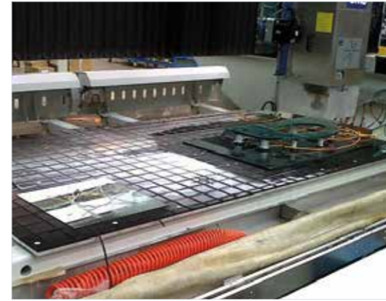
完全由橡胶制成的吸入工作台面
