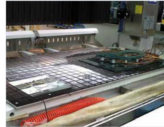
Saugarbeitsplatte vollständig aus Gummi.
