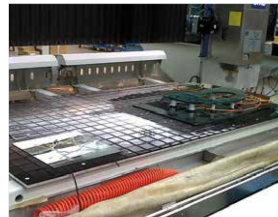
Полностью обрезиненный рабочий стол с вакуумной системой закрепления заготовок
