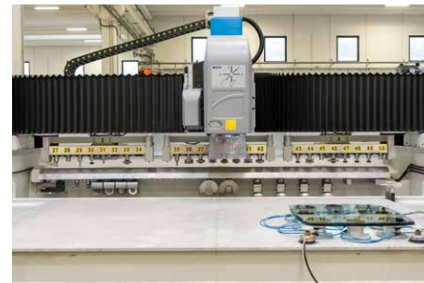
Расположенный под траверсой магазин инструментов на 24 позиции
