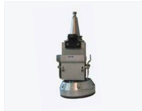
Держатель полировальных кругов с углом наклона 5° для снятия фаски
