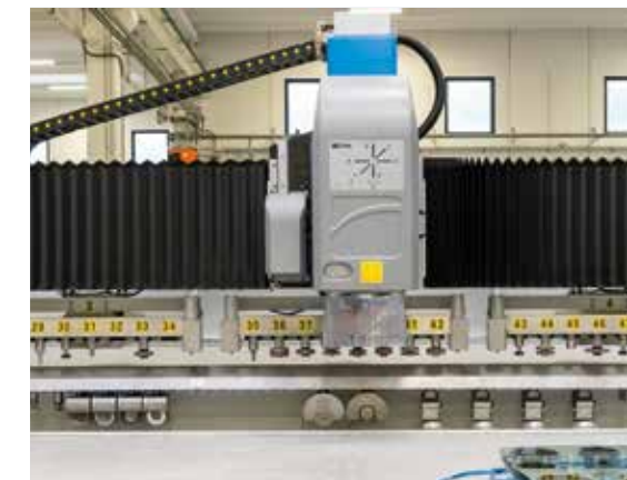
Расположенный под траверсой магазин инструментов на 24 позиции
